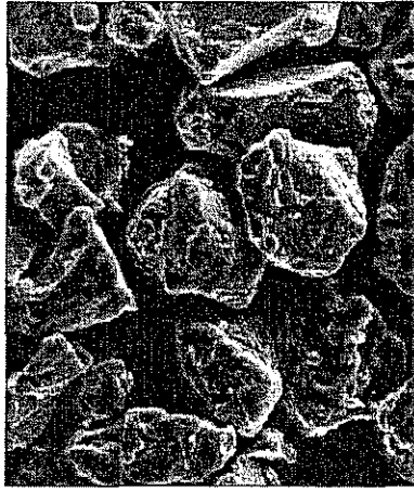
Herkömmlicher Toner, mittlerer Durchmesser 12 µm
