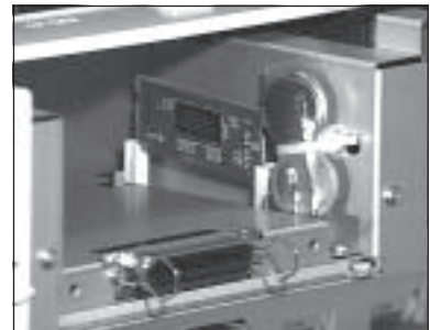
Klammer lösen und Platine nach oben herausnehmen
