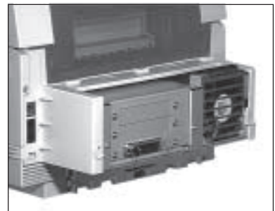
Klammer lösen und Platine nach oben herausnehmen
